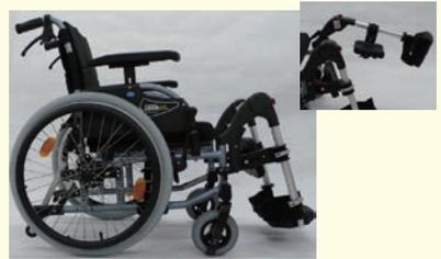
■車輪のサイズと取付位置により(前座高・後座高)を調整できます。
